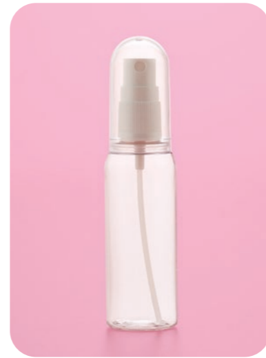
TSL-60ML (II) (OC) 満容量 (OFV) : 67.0mL サイズ : 径φ33.5×高さ103.2mm 材質 : PET オーバーキャップ : TSOC-28.8×53.5 (材質 : SBC) ポンプ : PAV 18/415 (P.18参照)
