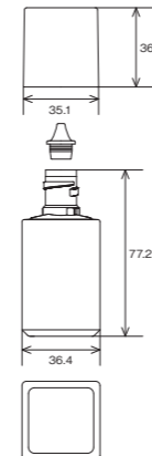
TSL-50ML (M) 満容量 (OFV) : 57.0mL サイズ: 幅36.4×奥行き36.4×高さ77.2mm 材質: EVOH/LDPE 2パーツキャップ: TSC-35×36 (材質: ABS/PP) 中栓: TPG-10.3×16.4 (B) (穴径φ1.5・材質: LDPE) ※多層対応可
