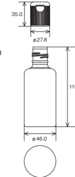
TSL-90ML (II) 満容量 (OFV) : 130.0mL サイズ : 径φ46×高さ115mm 材質 : HDPE キャップ : TSC-27×35 (H) (穴径φ4・材質 : PP)
