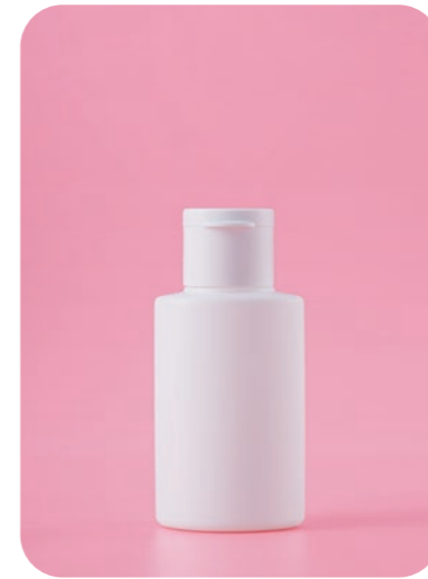
TSL-60ML (III) 満容量 (OFV) : 76.0mL サイズ : 幅46.2×奥行き31.8×高さ89.5mm 材質 : HDPE キャップ : TSC-28×24 (H) (穴径φ1.5・材質 : PP)
