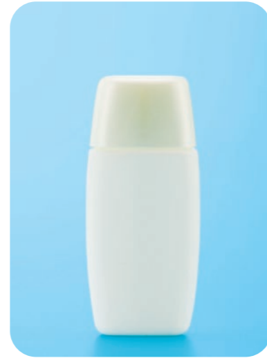
TSL-30ML (III) 満容量 (OFV) : 33.0mL サイズ: 幅36.5×奥行き21.0×高さ80.8mm 材質: HDPE キャップ: TSC-34×22 (材質: PP)
