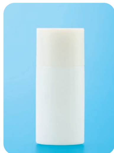
TSL-30ML (M) 満容量 (OFV) : 36.0mL サイズ: 幅36.5×奥行き25.0×高さ76.7mm 材質: EVOH/HDPE キャップ: TSC-36×28 (材質: PP) 中栓: TPG-10.3×16.4 (B) (穴径φ1.5・材質: LDPE) ※多層対応可
