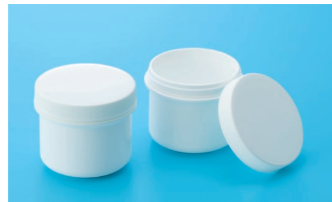
TSJ-140 満容量 (OFV) : 140.0mL サイズ: 径φ69.7×高さ56.2mm 材質:HDPE キャップ:TSC-69×11 (材質:PP)
