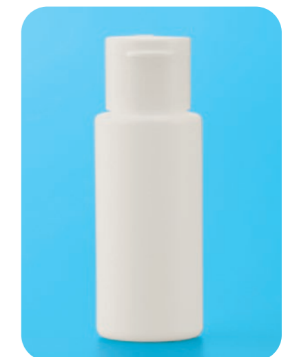
TSL-50ML (II) 満容量 (OFV) : 67.2mL サイズ: 径φ35.3×高さ90.0mm 材質: HDPE キャップ: TSC-28×24 (H) (穴径φ1.5・材質: PP)
