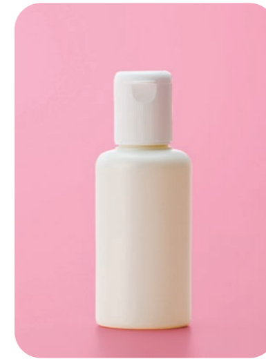
TSL-90ML (II) 満容量 (OFV) : 130.0mL サイズ : 径φ46×高さ115mm 材質 : HDPE キャップ : TSC-27×35 (H) (穴径φ4・材質 : PP)
