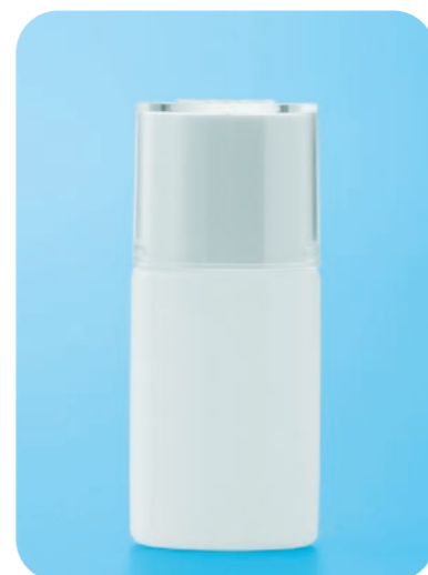
TSL-40ML (M) 満容量 (OFV) : 42.2mL サイズ: 幅38.0×奥行き27.0×高さ75.8mm 材質: EVOH/HDPE 2パーツキャップ: TSC-38×33 (材質: PET/PP) 中栓: TPG-10.3×16.4 (B) (穴径φ1.5・材質: LDPE) ※多層対応可
