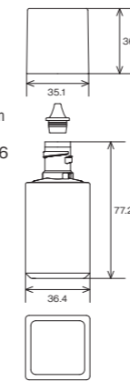
TSL-50ML (M) 満容量 (OFV) : 57.0mL サイズ: 幅36.4×奥行36.4×高さ77.2mm 材質: EVOH/LDPE 2パーツキャップ: TSC-35×36 (材質: ABS/PP) 中栓: TPG-10.3×16.4 (B) (穴径φ1.5・材質: LDPE) ※多層対応可
