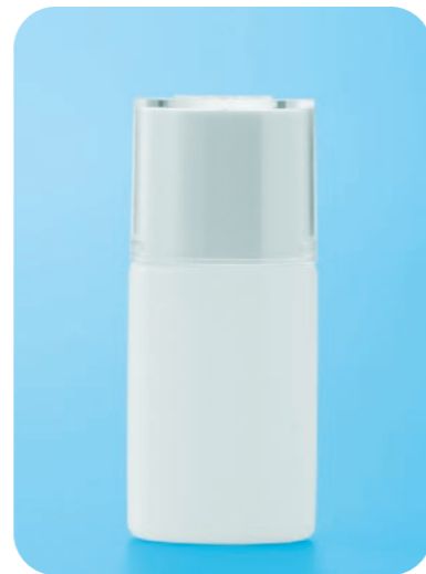
TSL-40ML (M) 満容量 (OFV) : 42.2mL サイズ: 幅38.0×奥行27.0×高さ75.8mm 材質: EVOH/HDPE 2パーツキャップ: TSC-38×33 (材質: PET/PP) 中栓: TPG-10.3×16.4 (B) (穴径φ1.5・材質: LDPE) ※多層対応可
