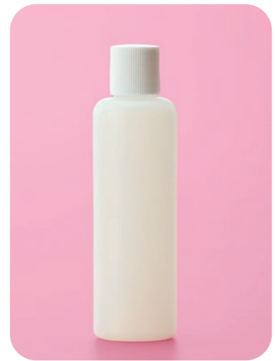
TSL-195ML 満容量 (OFV) : 200.0mL サイズ : 径φ46.8×高さ160.5mm 材質 : HDPE キャップ : TSC-28×28(材質 : PP) 中栓 : TPG-15.9×12 (穴径φ4.3・材質 : LDPE)
